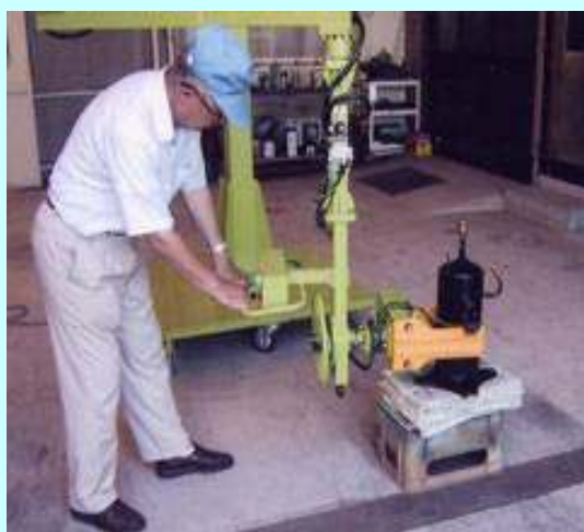
エアコン用部品のクランプ／反転 Air Con Compressor Clamp / Rotate
