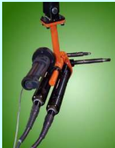
ドア固定用ボルトの締め付け Bolt tighten for door load
