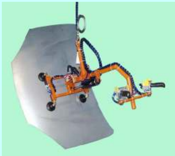
フード 吸着 Hood Vacuum
