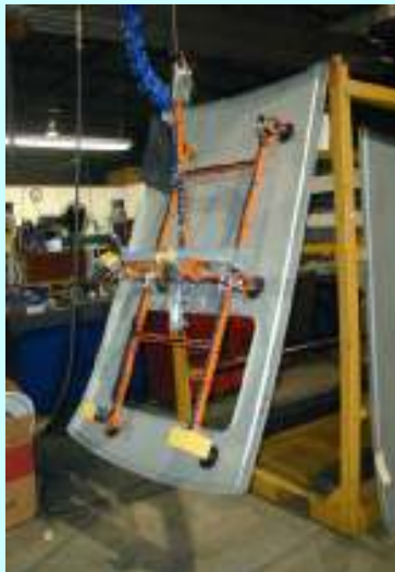
ルーフパネル 吸着 Roof Panel Vacuum
