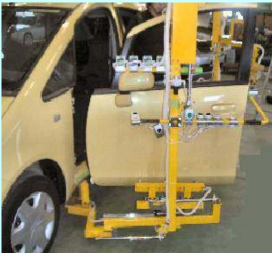
車両下部への押し当てによる同期 Synchronized by push clamp under the body
